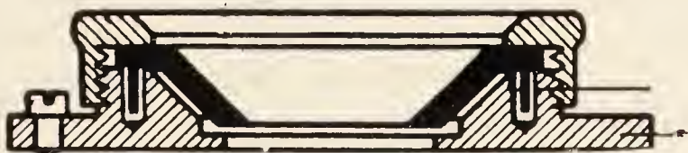
Abb. 51. Halter für die Quarzkammer zum Kardiod- Ultramikroskop.
